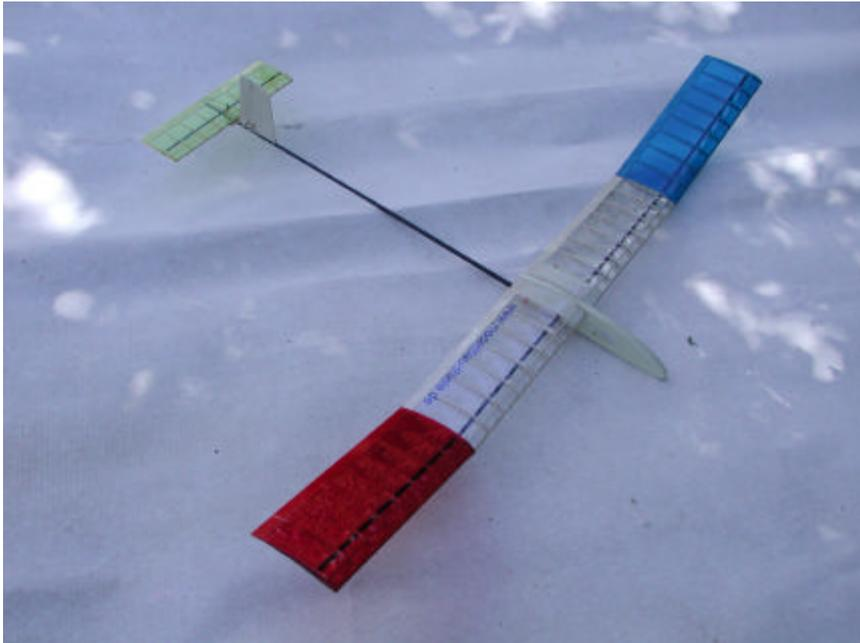
Der Habicht ist die Weiterentwicklung unseres Käuzchens. Das Flügelprofil mit konkaver Unterseite realisiert geringe Fluggeschwindigkeiten, wodurch auch bei 0-Wind Starts kein Problem mehr darstellen. Der Rumpf stammt vom Merlin. Die Nasenleisten sind aus Buchenrundstäben und bieten bei Kollisionen genügend Festigkeit.
