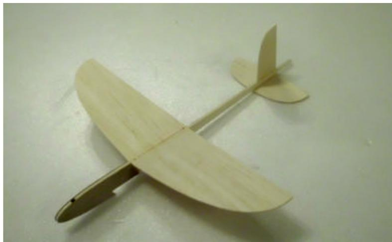
Nun muss das Modell noch ausgewogen werden. Das heißt der Schwerpunkt wird eingestellt. Dieser liegt 25 mm hinter der Flügelvorderkante.
