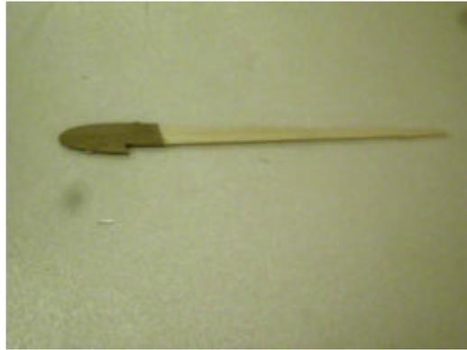
Als nächstes trennen wir das Höhenleitwerk (Teil 2) heraus, verschleifen es vorsichtig und kleben es schön rechtwinklig 2 cm vor dem Ende von unten an den Rumpf. Ebenso verfahren wir mit dem Seitenleitwerk, das natürlich von oben an den Rumpf angeklebt wird (Teil3).
