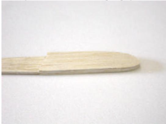
Als nächstes trennen wir das Höhenleitwerk (Teil 2) heraus, verschleifen es vorsichtig und kleben es schön rechtwinklig von unten an den Rumpf. Ebenso verfahren wir mit dem Seitenleitwerk, das natürlich von oben an den Rumpf angeklebt wird (Teil3).
