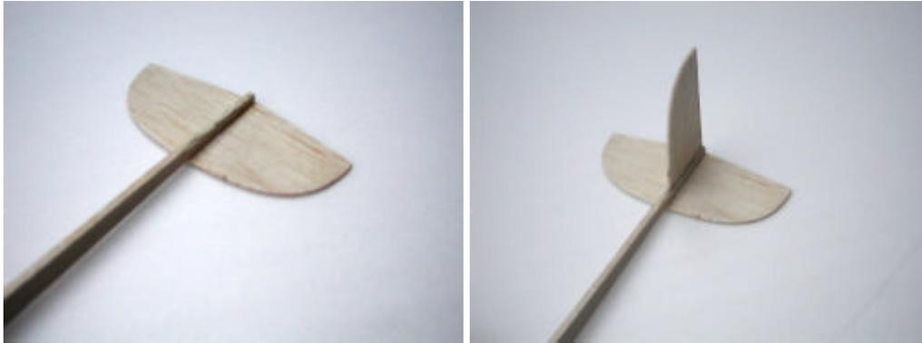
Der Flügel wird auch aus dem Brettchen getrennt, versäubert und genau mittig (die Löcher sind eine Orientierungshilfe) etwa 0,5 mm tief eingeschnitten, **aber nicht durchgetrennt!** Nun wird eine Flügelhälfte ca. 30 mm nach oben geknickt, der Schleifklotz darunter platziert und die Trennstelle mit etwas Kleber versehen. Das Ganze muss gut durchtrocknen
