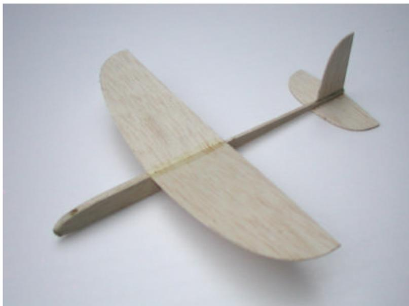
Nun muss das Modell noch ausgewogen werden. Das heißt der Schwerpunkt wird eingestellt. Dieser liegt 25 mm hinter der Flügelvorderkante.
